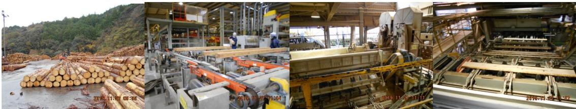
森林法により資源管理（55 年）された桧が一日 30 リッポウ搬入され、大きさ長さにより製材工程を分け、製材工程に入ります。
