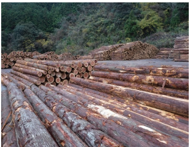
杉の芯材部分の赤い所は害虫に対して強く 住宅の外装部分に使われることが多い 例：神社、仏閣 最近では戸建て住宅の外装材としても使用される
