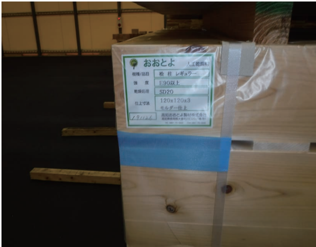
柱材： 120×120×3000 桧 強度：E90以上 SD20%以下
