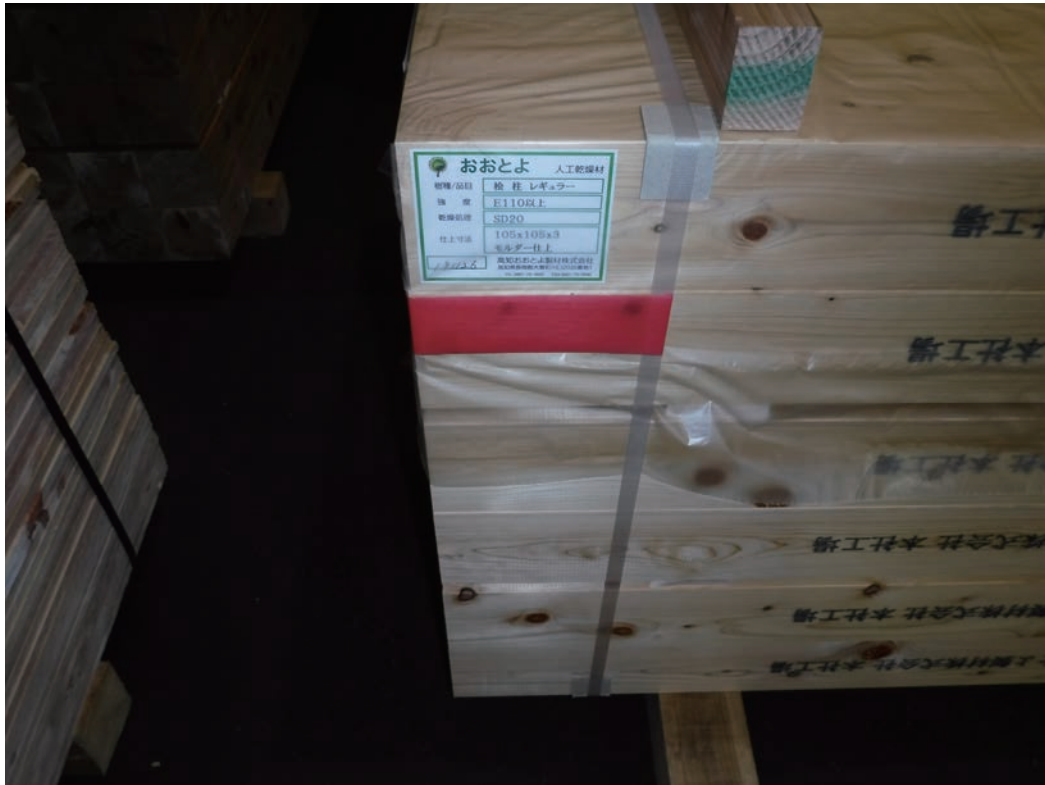
柱材： 120×120×3000 桧 強度：E110以上 SD20%以下
