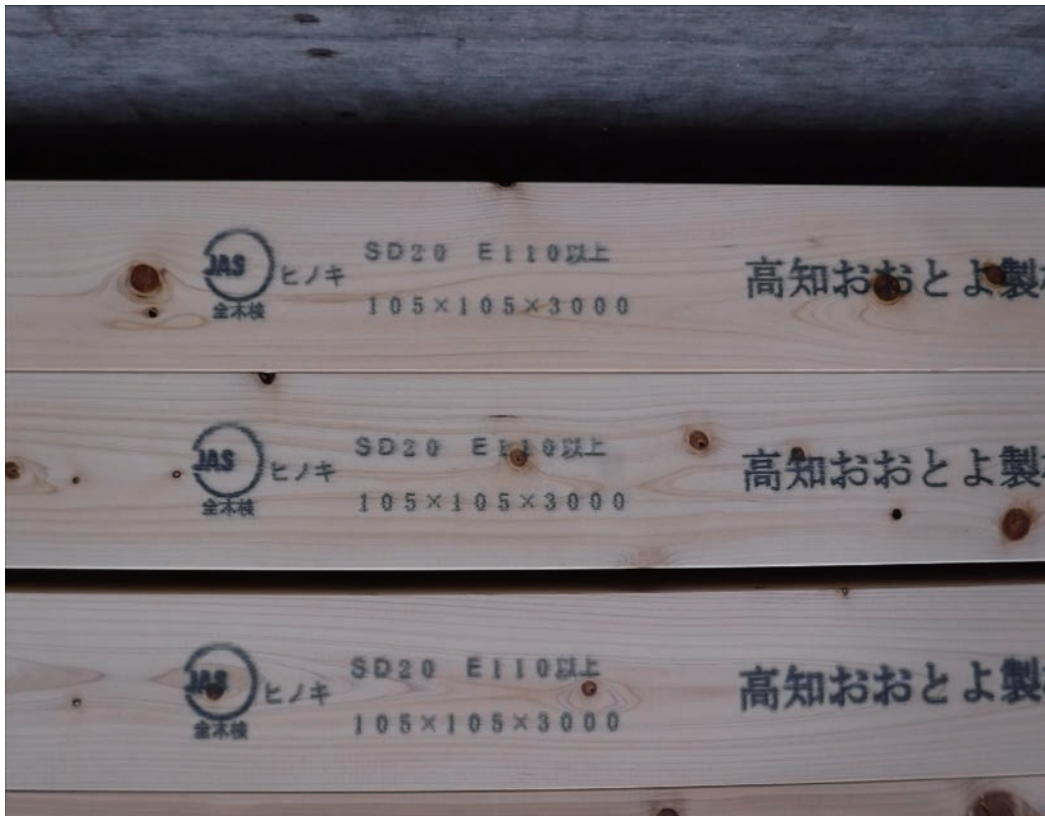
柱材： 105×105×3000 桧 JAS材 強度：E110以上 SD20%以下
